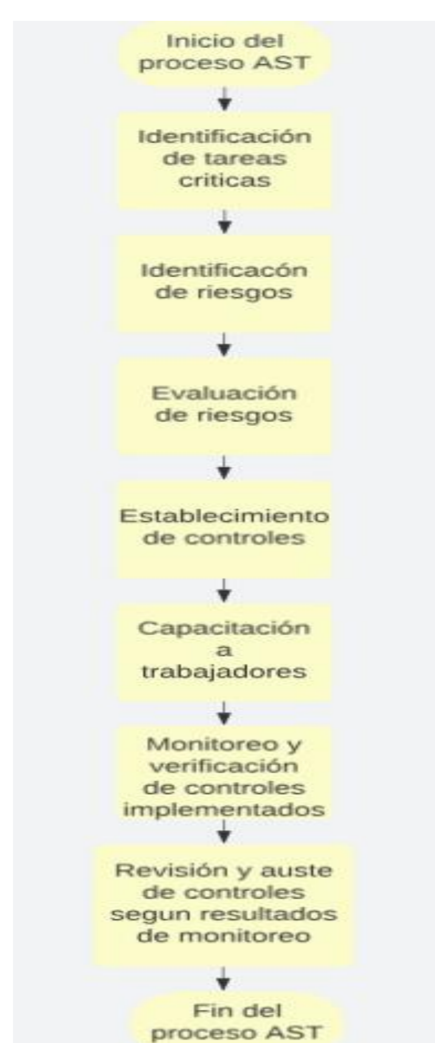
Gráfico 1.2 Diagrama de flujo de proceso AST
