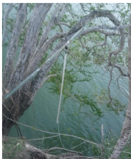
Figura 5. Montaje en el río Pánuco del sensor de ultrasonido para la medición de nivel.
